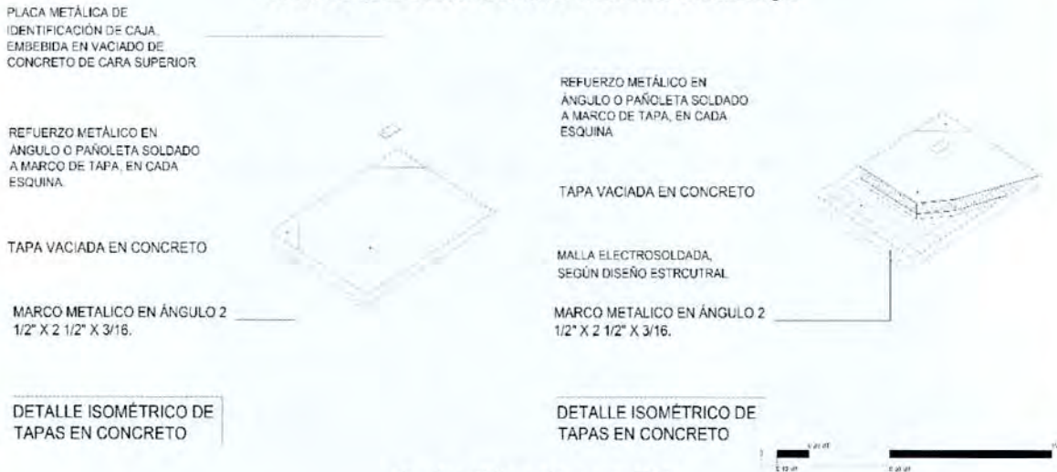
Gráfica 6. Detalle de construcción de la tapa
